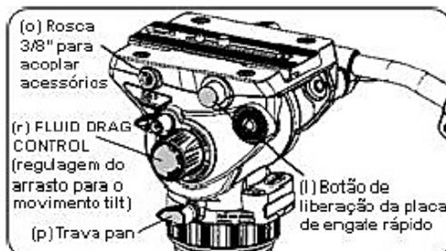
A placa de engate rápido vem com parafusos de rosca 1/4" e 3/8". O parafuso que não for usado pode ser fixado por baixo da parte superior da cabeça (f).
